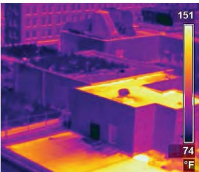
Temperaturunterschiede zwischen einem begrüntem und einem konventionellen Dach. Das begrünte Dach ist ungefähr 40°C kühler (dies entspricht 80°F) als das benachbarte konventionelle Dach.
